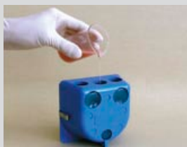
Obr. 15 Licí pryskyřici Interacryl CAST nalijte tenkým proudem do kyvety.
