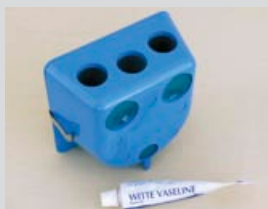
Obr. 14 Vložte model do kyvety. Povrch kyvety v okolí licích otvorů lehce potřete vazelínou.
