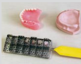
Obr. 10 Po vyjmutí z voskového modelu umístěte pryskyřičné zuby do speci- álního držáku a očistěte je vroucí vodou nebo párou.
