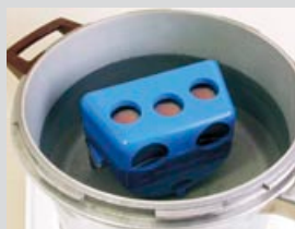
Obr. 17 Kyvetu vložte do vodní lázně 45 °C teplé. POZOR! - Licí otvory musí být nad vodou.
