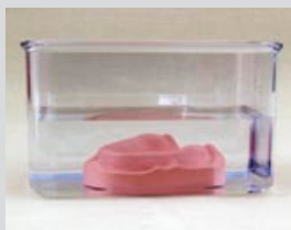
Obr. 11 Po odstranění vosku namočte sádro- vý model na 5 minut do vlažné vody.
