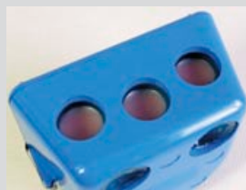
Obr. 16 Před vložením kyvety do polymeračního hrnce musí povrch pryskyřice zmatnět.
