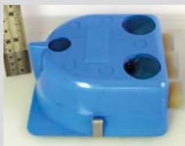
Obr. 7 Kyvetu ponořte 4 cm hluboko do vodní lázně. Gelodouble ztuhne po 40 minutách.
