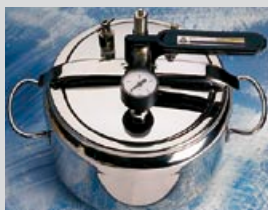
Obr. 18 Polymerujte v polymeračním hrnci nebo tlakovém polymerátoru za tlaku 2,5 bar, teploty 45 °C po dobu 30 minut.
